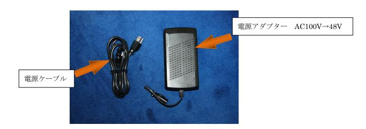
8. ADCP 通信ケーブルの電源コネクターと、電源アダプターのコネクターを接続します。 ネジを締め込むと接続出来ます。
