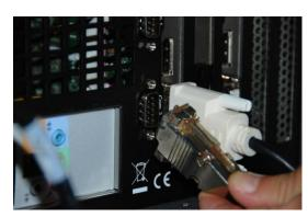
PC に接続コネクターがある場合は、 直接 ADCP ケーブルを差し込んでく ださい。 4. ADCP コミュニケーションケーブルのシリアル側と PC のシリアルコネクターを接続してください。
